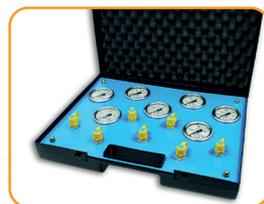
Strumenti portatili prova pressione
