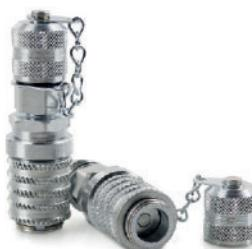
Innesto rapido femmina: innestandolo sul maschio consente il controllo dei parametri della pressione dell'olio in un impianto oleodinamico. Si adatta al sistema di misurazione Mini Press, grazie ad una minipresa con filetto di uscita M 16x2 per attacco a microtubo raccordato o portamanometro, avvitata su di esso.
