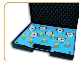
Strumenti portatili prova pressione
