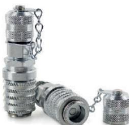
Innesto rapido femmina: innestandolo sul maschio consente il controllo dei parametri della pressione dell'olio in un impianto oleodinamico. Si adatta al sistema di misurazione Mini Press, grazie ad una minipresa con filetto di uscita M 16x2 per attacco a microtubo raccordato o portamanometro, avvitata su di esso.
